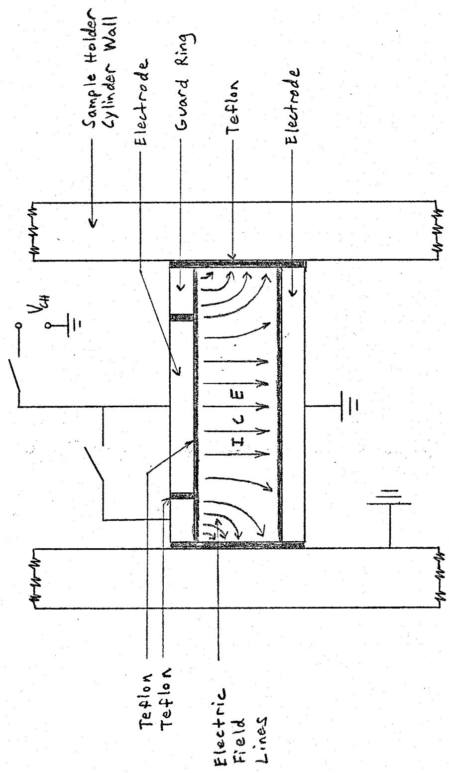
GUARD RING ARRANGEMENT FOR FLAT DISK SAMPLE HOLDER
